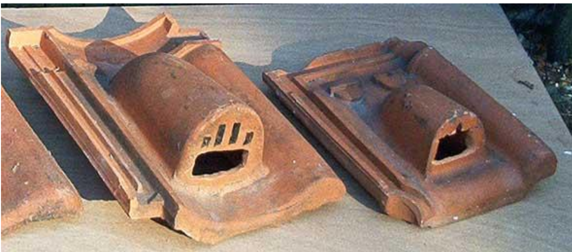
Uitgezaagde ventilatiepannen: OVH en Tuile du Nord
